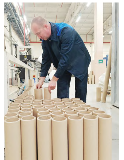
Машинист экструдера Виктор АГУРЦОВ нарезает патроны необходимой ширины.
