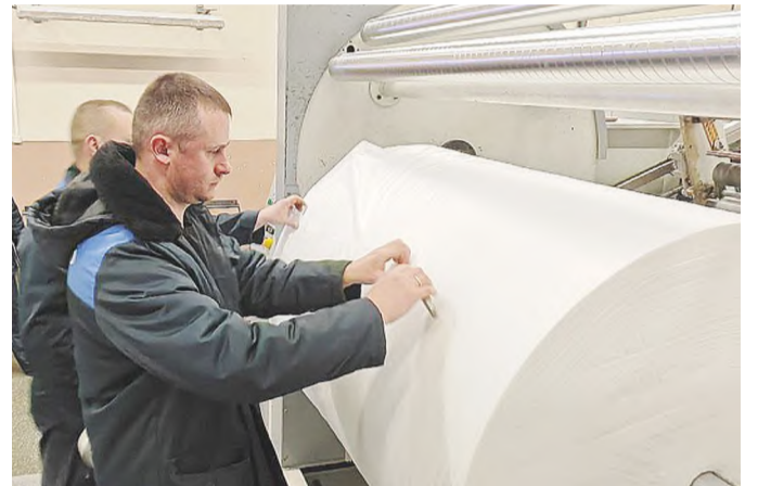
Помощник мастера Юрий ПИЩИК и машинист экструдера Александр КОСАЧ производят сьем наработанного нетканого материала гигиенического назначения.
