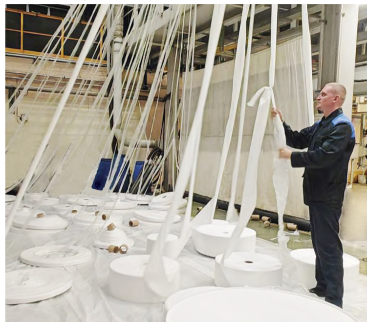
Машинист экструдера 6 разряда Алексей ГРИШКОВ, подвязывает кромочные полосы в обратный экструдер.
