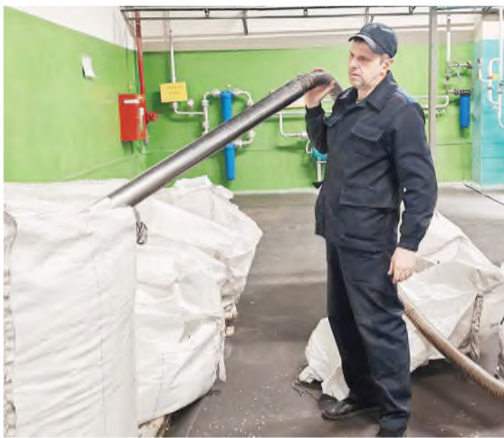
Машинист экструдера Андрей ТЕЛЕПУН выполняет загрузку агломерата.
