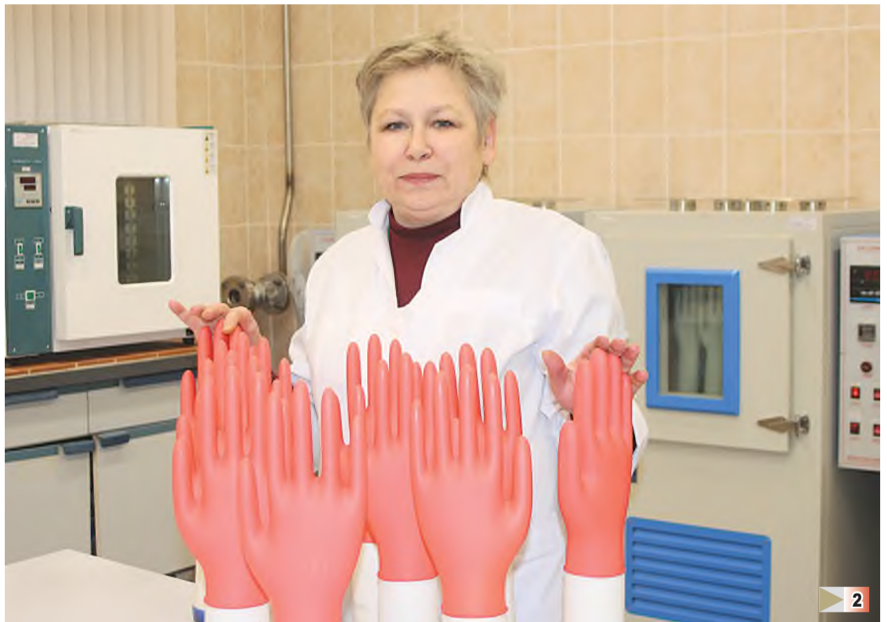
Лаборант химического анализа Галина ТУЗ демонстрирует только что полученные лабораторные образцы перчаток из нитрильного латекса. Галина Михайловна - одна из немногих, кто работал над рецептурой первой нитриловой перчатки в ЦПМП.
