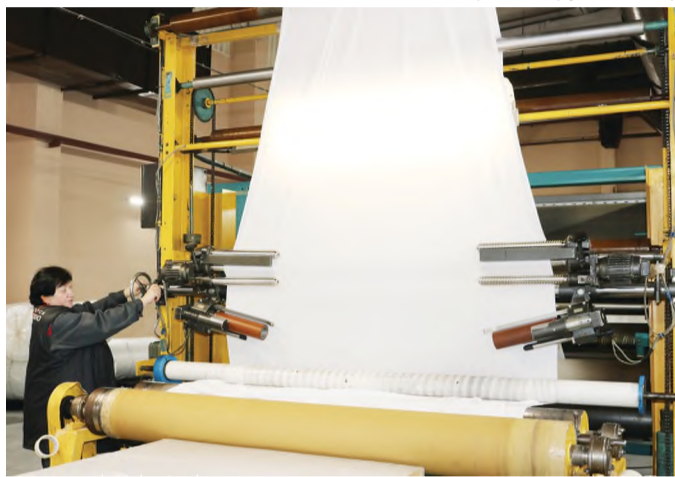
Татьяна АСТАХОВА, сортировщик сырья, материалов и изделий устанавливает кромкорасправитель на компактирующем каландре SOFTEC-A
