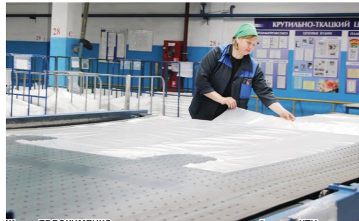
Жанна ЕВДОКИМЕНКО, машинист автоматизированной линии КТЦ изготавливает полиэтиленовые вкладыши МКР.
