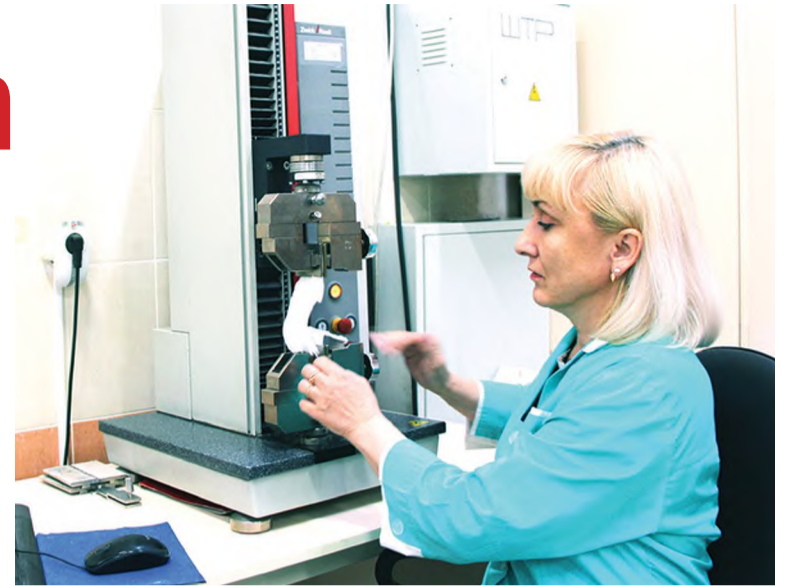
Дневной контролёр качества продукции и технологического процесса Валентина БОЛДУЗЕВА проводит испытания на разрывной машине.
